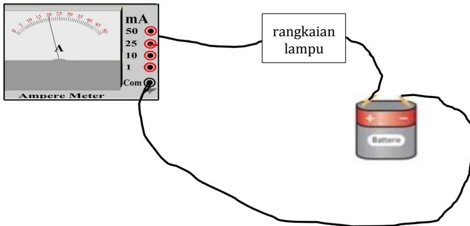
Beberapa lampu dirangkai pada kotak rangkaian lampu sehingga arus yang mengalir saat seperti yang terbaca dalam ampere meter dan beda potensial diujung-ujung rangkaian lampu 0,514 volt. Pilihan lampu yang dirangkai serta ukurannya seperti tabel dibawah ini:
